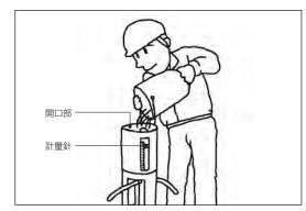
④排水バルブが閉じていることを確認後、水面が計量針を越えるまで、タンク上部の開口部から水をタンク内に供給します。余分な水の排水が終了後、排水バルブを開け、計量した水をペール缶などへ排水します。
